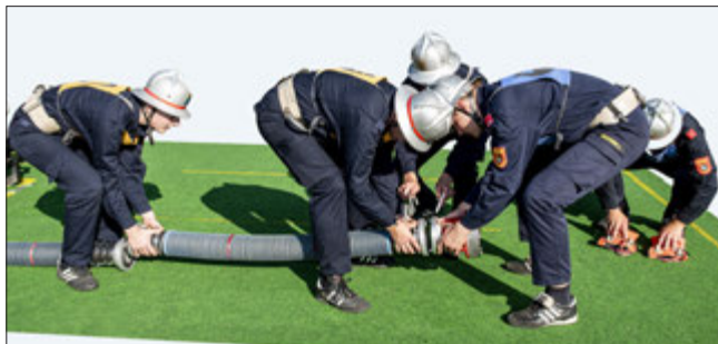
Abb. 20: Aufnahme des ersten Saugschlauches zum Ankuppeln des Saugkorbes (ÖBFV)
