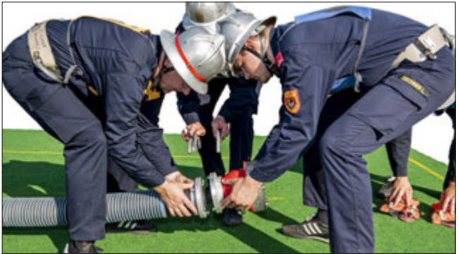
Abb. 22: Händisches Ankuppeln des Saugkorbes und Übergabe der Kupplungsschlüssel (ÖBFV)
