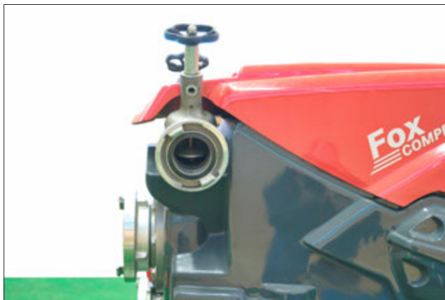
Abb. E05: Richtige Knaggenstellung TS-Ausgang (ÖBFV)
