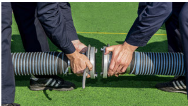
Abb. 29: Kuppeln der Saugschläuche mit angesetzten Kupplungsschlüsseln (ÖBFV)
