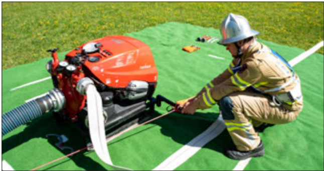
Abb. 39: Richtiges Befestigen der Saugschlauchleine (LFV Tirol)
